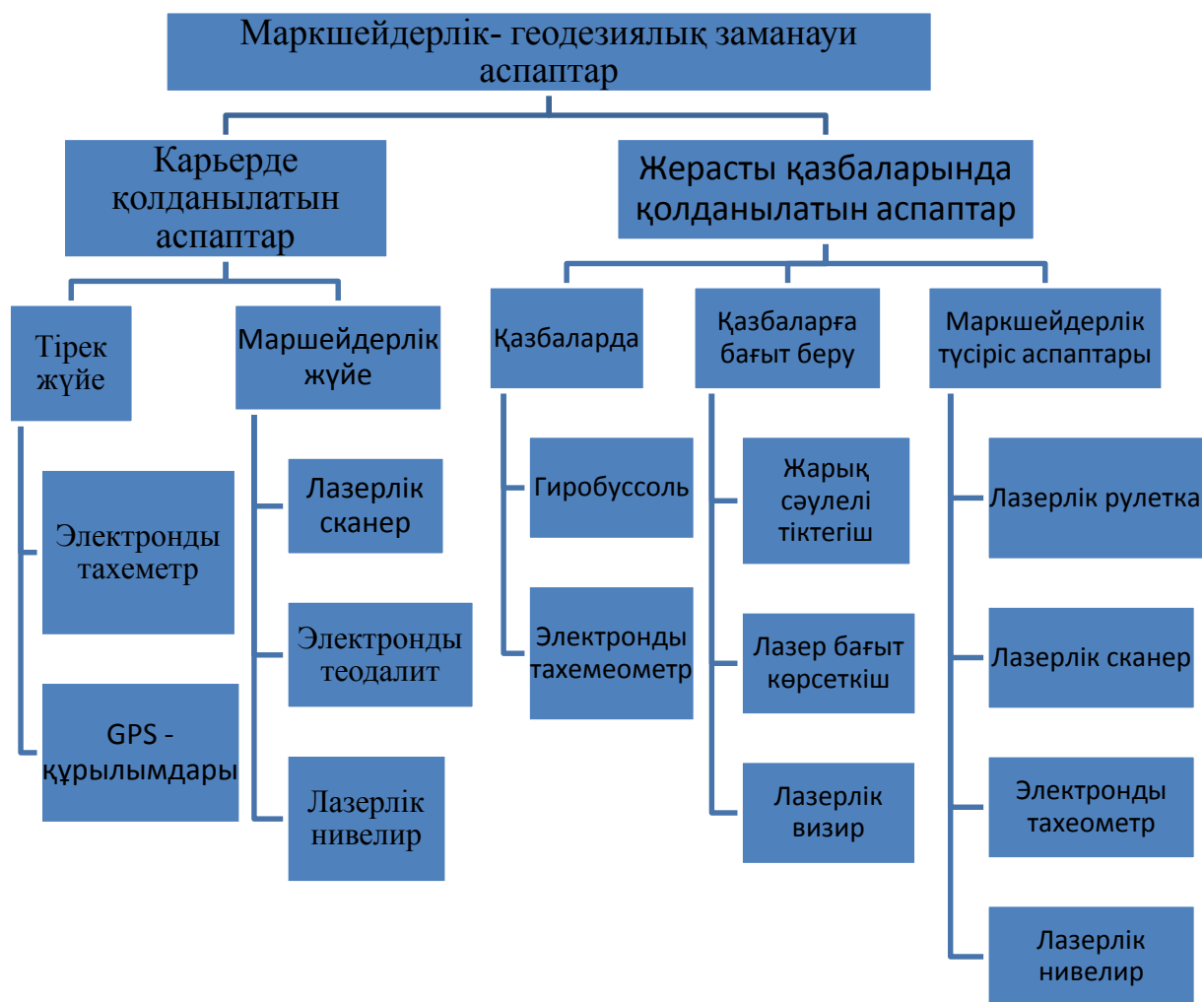
18 Сурет – Маркшейдерлік - геодезиялық заманауи аспаптардың жіктемесі
